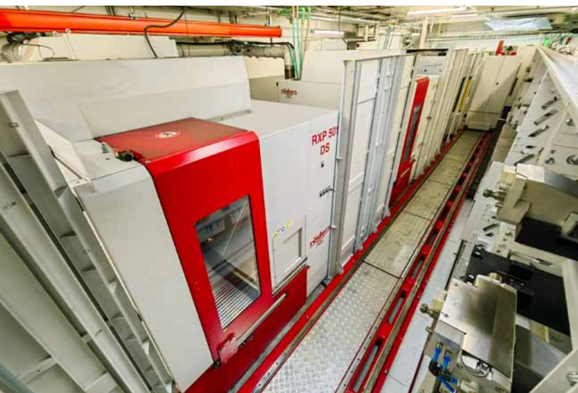
Innenansicht der Fertigungslinie: Vorne links die 5-achsige RXP501 DS, gefolgt von der 3-achsigen RXP501. Im Hintergrund auf der Linearschiene der äußerst schmal bauende Roboter RCF150 (Foto: Klaus Vollrath)
