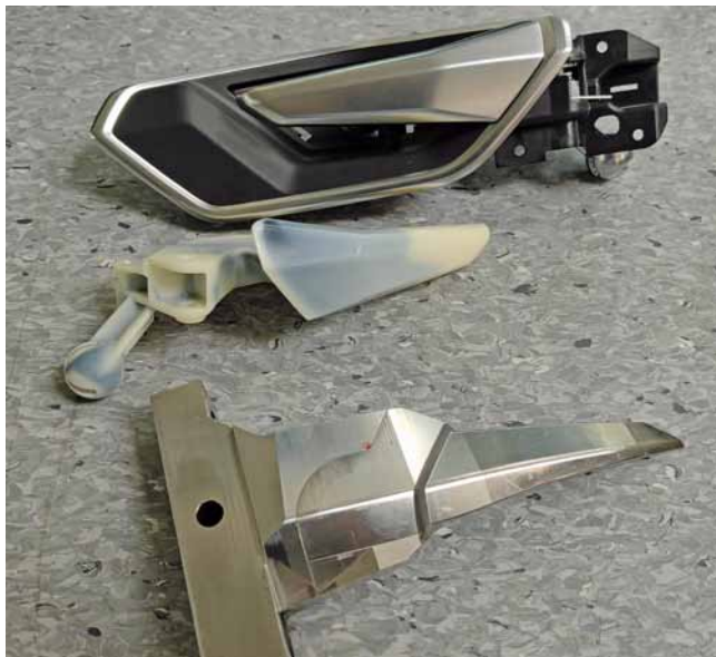
Sicherheitsteil Türinnenbetätigung: Dieses Bauteil darf auch dann nicht brechen, wenn Insassen z. B. im Notfall mit aller Kraft daran reißen. Oben die fertige Baugruppe, in der Mitte das unbeschichtete Spritzgussteil, unten der bewegliche Kern des entsprechenden Werkzeugs (Foto: Klaus Vollrath)
