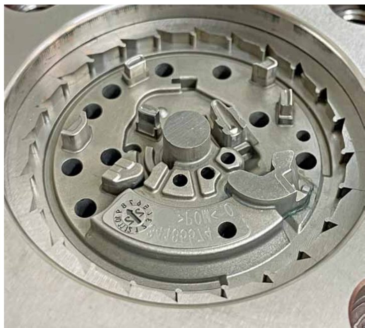
Formeinsatz für ein aufwendiges Kunststoff-Zahnrad für das Gurtstraffersystem eines Autos. Bei diesem Sicherheitsteil werden bei einem Werkzeug mit 8 Kavitäten Flächenprofile mit einer Toleranz von lediglich 40 µm am fertigen Bauteil vorgegeben (Foto: SFS)
