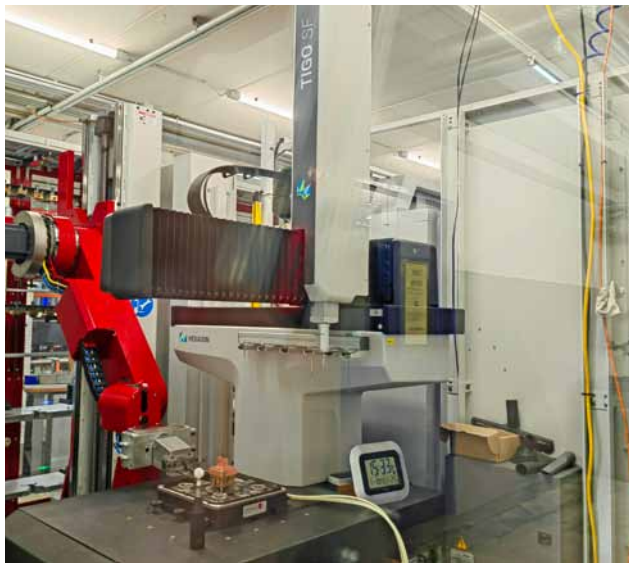
Präzision muss dokumentierbar sein: Das Hexagon-Koordinatenmessgerät erreicht eine Genauigkeit von 1 µm. Beim Beladen demonstriert der Linearroboter seine hervorragende Reichweite bei minimalem Bauraum (Foto: Klaus Vollrath)
